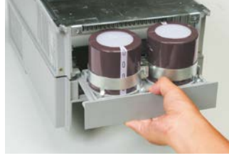
Kolay sökülebilir DC veri yolu kapasitörleri (SJ700B: 18,5 kW üzeri)
